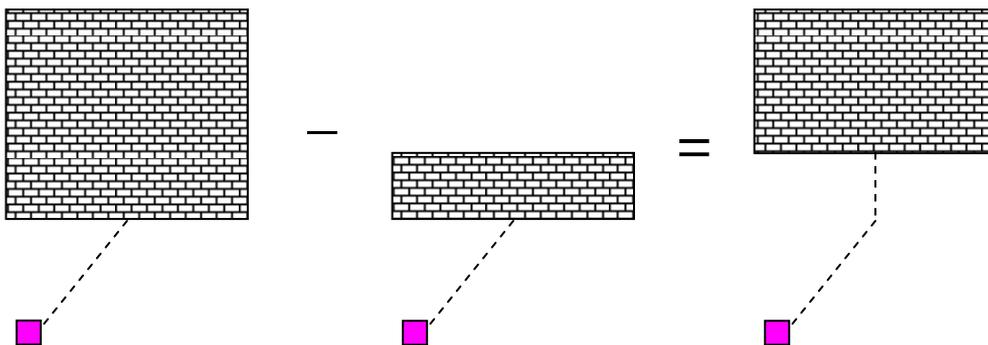
Les paramètres d'entrée sont les dimensions de la surface émissive (hauteur et largeur de flamme), la hauteur de la cible et sa distance par rapport à la flamme.
