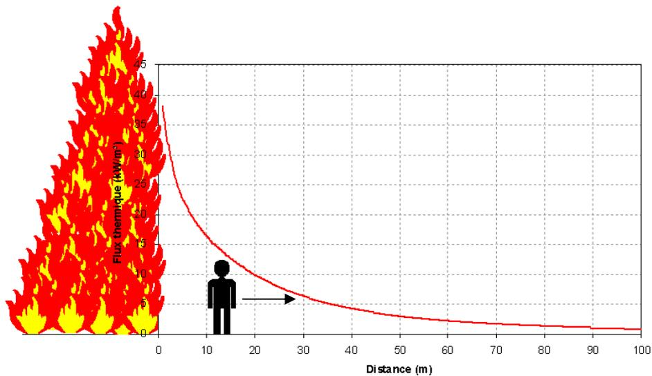
Plus la cible s'éloigne du foyer, plus la transmittance de l'air diminue et plus le facteur de forme diminue. Ainsi plus la cible s'éloigne, plus le flux qu'elle reçoit diminue.
