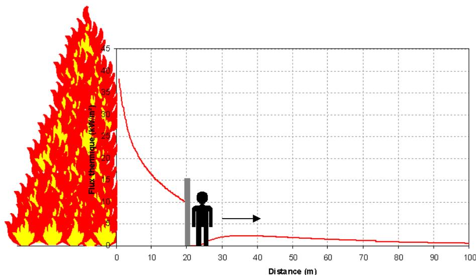
Jusqu'à l'écran déporté le flux reçu est le même que lorsqu'il n'y a pas d'écran. Lorsque la cible passe derrière l'écran, elle ne voit plus ou peu le foyer. Le flux reçu devient donc très faible. Lorsque la cible s'écarte de l'écran, l'angle de vue sous lequel elle voit le foyer augmente à nouveau puis la distance devient prépondérante. Il se produit alors le même phénomène qu'avec l'écran en façade. Le flux thermique augmente puis diminue.
