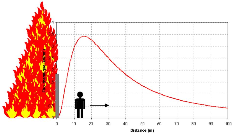
Lorsque la cible est derrière l'écran, elle ne voit pas ou peu les flammes. L'angle de vue sous lequel elle voit le foyer est donc faible. En revanche il augmente sensiblement lorsque la cible s'éloigne du mur. Ainsi la cible reçoit un flux thermique de plus en plus intense. Si la cible continue de s'éloigner, l'influence de la distance devient prépondérante et le facteur de forme diminue à son tour. Le flux reçu diminue également.
